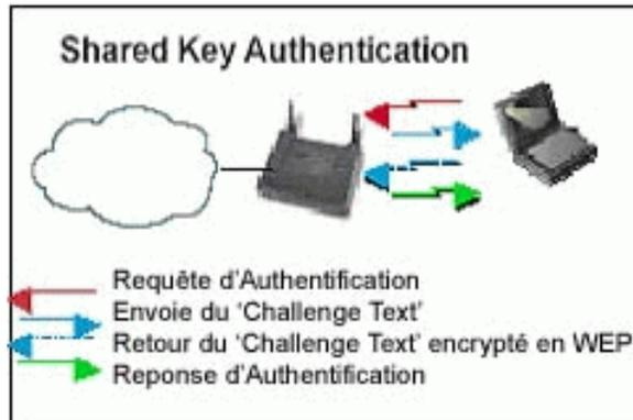
Dans le processus partagé d'authentification, le client envoie tout d'abord une demande à l'access point, qui lui renvoie une 'challenge text'. Le client doit encrypter ce texte en utilisant sa clef WEP (configurée au préalable). Le client retourne ensuite le paquet à l'access point et si celui-ci arrive à décrypter correctement ce fichier, l'authentification a réussi.
