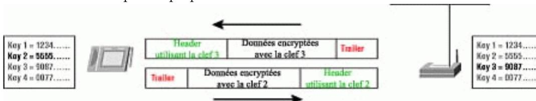
Les Headers et Trailer sont ajoutés au corps encrypté du paquet, la clef qui à été utilisée pour encoder le corps est indiquée dans la partie KeyID du Header ainsi qu'un vecteur d'initialisation, une valeur de contrôle d'intégrité est incluse dans le trailer.
